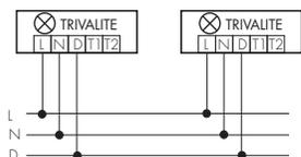
Pour la communication entre plusieurs luminaires, un seul fil de données «D» (topologie bus) suffit. La longueur maximale autorisée du fil de données «D» est de 1 km.
