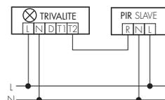
Dans la configuration d'usine, un détecteur de présence esclave B.E.G. peut être connecté à l'entrée T2, afin d'étendre la zone de détection.
