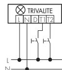
Pour un'installation encore plus facile, voir l'application de bouton-poussoir radio avec le commutateur de fonctionnement pour le luminaire.
