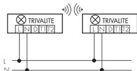
Pour la communication entre plusieurs luminaires, un réseau radio peut être monté en remplacement de la communication Filaire. Le réseau radio fonctionne également sans restrictions sur plusieurs groupes de fusibles.
